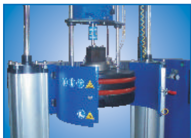
Sistema de protección del plato fusor para evitar que el operario pueda quemarse o quedar atrapado.
