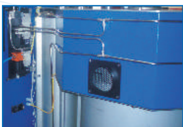
Sistema de extracción de humos.
